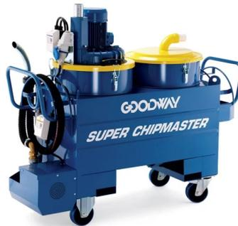
DV-СМ4 – пылесос для сбора стружки / восстановления смазочно-охлаждающей жидкости, включающий сетку для металлической стружки на 83 л., нейлоновый и полипропиленовый фильтры, резервуар для сбора жидкости на 250л. галлонов, рукоятки, колеса, перекачивающий насос и клапан аварийного сброса.
